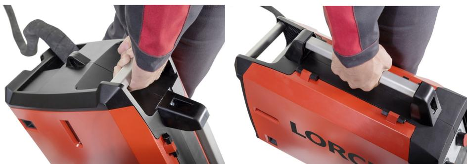
Прежде всего, при осуществлении монтажа или при действиях в труднодоступных местах необходимо размещать блок подачи проволоки непосредственно в месте проведения работ. В таких ситуациях блок подачи проволоки, стабильно располагаемый у источника питания и отличающийся особой гибкостью, подкупает, прежде всего, своими продуманными деталями. Там, где обычный монтажный блок зачастую имеет ручки лишь с одной
