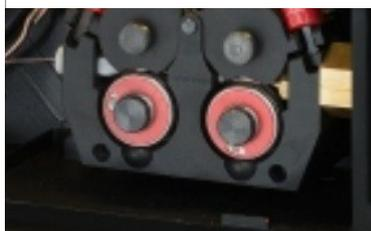
**Цветовая маркировка подающих роликов.** Путаница с установкой роликов осталась в прошлом. Подающие ролики Logch для MicorMIG с цветовой маркировкой обозначают различные диаметры проволоки и существенно облегчают жизнь сварщика.
